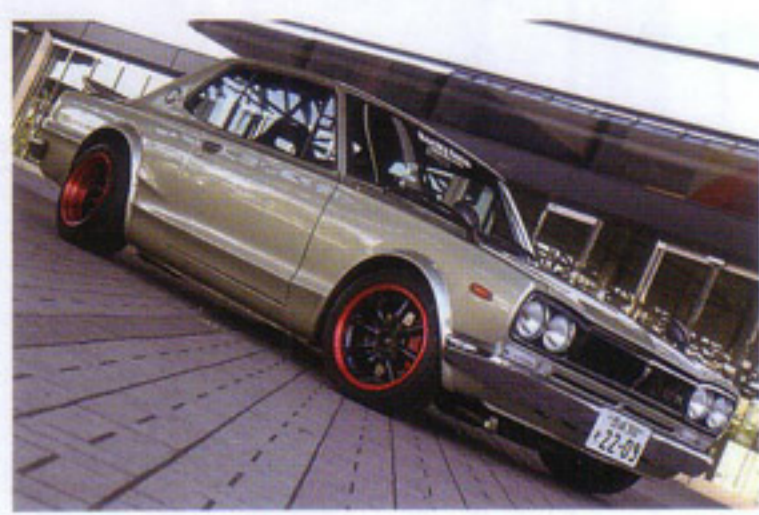
RSワタナベホイールはリムだけをアルマイトレッドで塗装。ヘッドランプはオート&HIDに変更して最新装備を意識した作りになっている。
